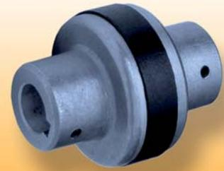
Il giunto GFI è realizzato da due mozzi in alluminio, con l'inserzione di un unico elemento elastico in gomma della durezza di 79 Shore-A. Il collegamento dei mozzi è del tipo ad innesto, per consentire un rapido montaggio e/o eventuale manutenzione.
