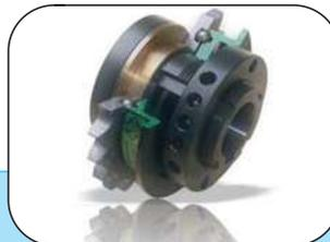
Dispositivo di sicurezza con lo stesso principio dei limitatori a frizione, ma con trasmissione mediante sfere e completo disinnesto alla coppia di taratura impostata. La coppia è regolabile modificando la pressione delle molle.
