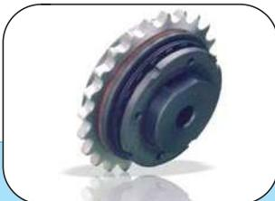
Dispositivo di sicurezza con corona montata tra due anelli di attrito che slittano senza disinnestarsi quando viene raggiunta la coppia di taratura impostata. La coppia è regolabile modificando la pressione delle molle.
