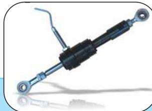
Dispositivo di sicurezza (lineare) che si disinnesta in direzione assiale (sia in compressione che in trazione) alla forza di taratura, ottenuta modificando la pressione delle molle.
