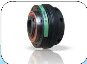
Dispositivo di sicurezza "senza gioco" con trasmissione mediante sfere che si disinnestano completamente alla coppia di taratura. Disponibile la versione negativa per avere un'elevata sensibilità. La coppia è regolabile modificando la pressione delle molle.
