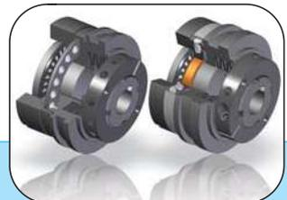
Dispositivo di sicurezza con trasmissione mediante sfere o rulli che si disinnestano completamente alla coppia di taratura impostata. La coppia è regolabile modificando la pressione delle molle.
