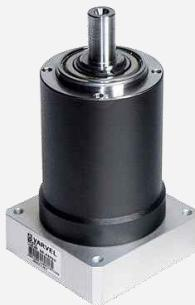
La serie dei riduttori epicicloidali a gioco ridotto tipo RG, costruita con carcassa monolitica in acciaio da bonifica sulla quale è ricavata mediante broccatura la corona dentata interna, può alloggiare 1 o 2 stadi di riduzione.
