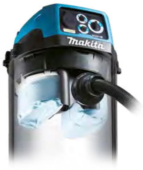
L'innovativo sistema di pulizia alternato dei filtri (modelli VC2211MX1, VC3211MX1 e VC3211HX1) permette di non ridurre la capacità di aspirazione. Durante la fase di pulizia le performance dell'aspiratore rimangono costanti grazie al sistema di gestione per singola unità filtrante. Mentre una unità è in fase di pulizia, l'altra prosegue la normale attività di filtraggio.
